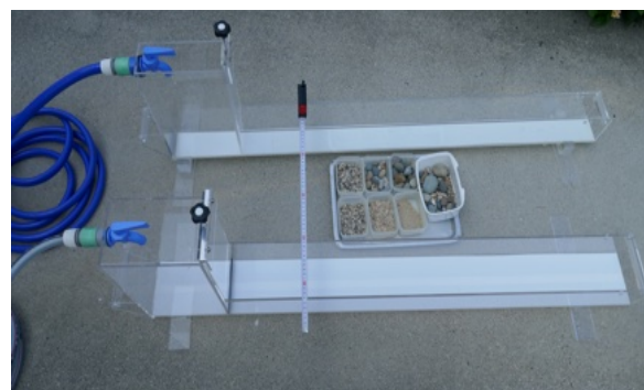
図 1 上方：流水モデル実験装置で水路幅が狭いタイプ、下方：同装置で水路幅が広いタイプ。中間にあるものは実験で流すための小石や砂。これらの構造、使用法などは発表時に提示する。
