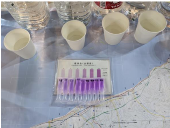
図1 持ち寄った水とパックテストの結果
