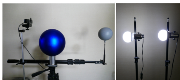
図3 左:三脚に載せた月・地球のモデル本体(青球=地球、灰色小球=月、装置の後方にwebカメラをセット) 右:太陽に見立てる2台のLEDランプ
