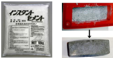
図1 インスタントセメントを型に流し込んで固める実験：約1日で硬化
