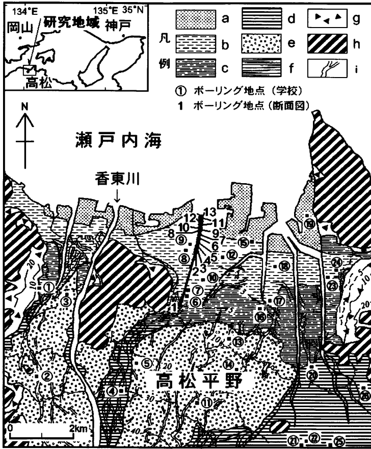
図1 調査地域の地形分類と調査地点の位置図 (高橋, 1987; Kawamura, 2003 を改変) a. 埋め立て地, b. 三角州 (標高3 m 以下), c. 三角州 (標高3~5 m), d. 氾濫原, e. 扇状地, f. 洪積台地, g. 崖錐・沖積錐, h. 山地, i. 旧河道 地点番号 1~13 とそれらを通る実線は、図3 における地質柱状図の位置とその配列を示す。地点番号①~⑬は、土質柱状図を検討した学校等の位置。イタリックの数値は等高線の標高(m)。
