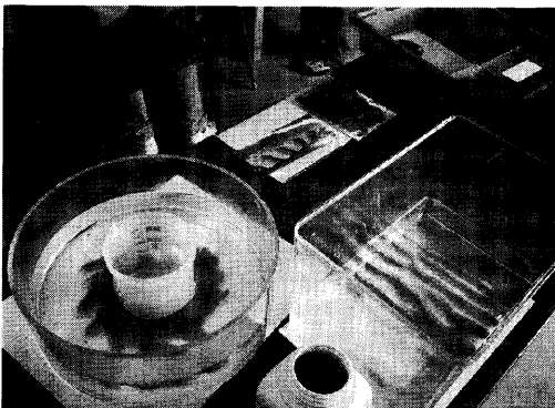
図 6 モデル実験 (3): 水槽にできたリップルマーク
