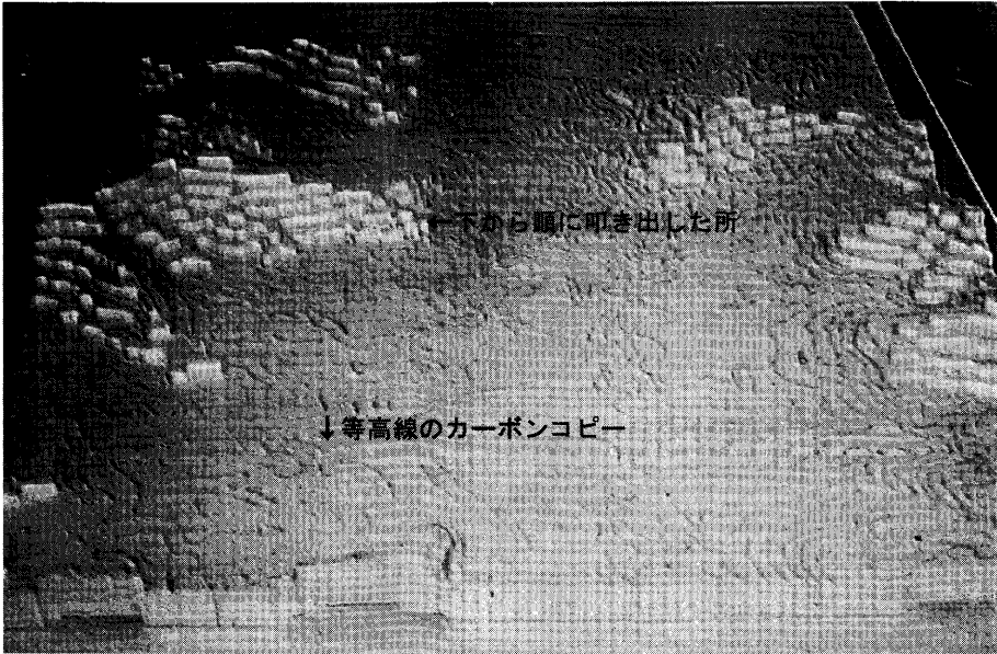
図4 叩き出し法で仮固定している様子 1 高度ずつ叩き出す。表面の線はカーボン紙による等高線。
