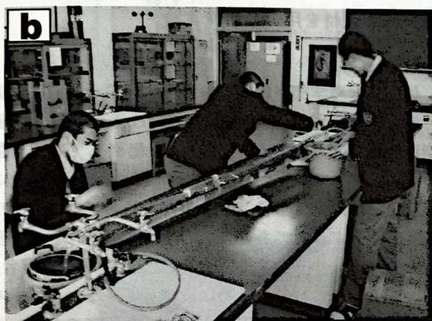
図3 ミニ水路の作り方と設置
