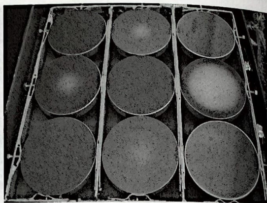
図8 アルミメッキが完了した9枚の主鏡
