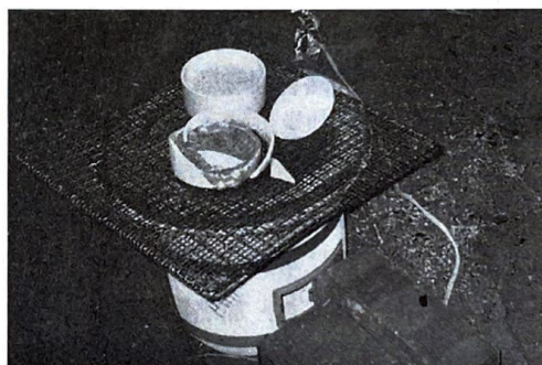
図6 加熱実験中に生じたアルミナルツボの破壊状況 奥側が破損前、手前が破損後の状態。
