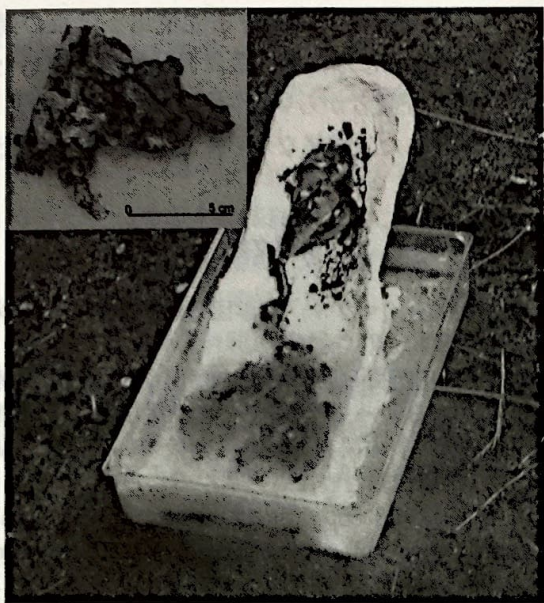
図15 生成したマグマをスロープに流し、水槽へ注いだ後の状況
