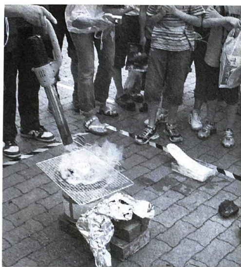
図4 七輪を用いたマグマ生成実験の様子（京都大学地球熱学研究施設本部（別府）の施設一般公開（2010年7月に実施） 上部よりガスバーナーで試料表面を加熱している。
