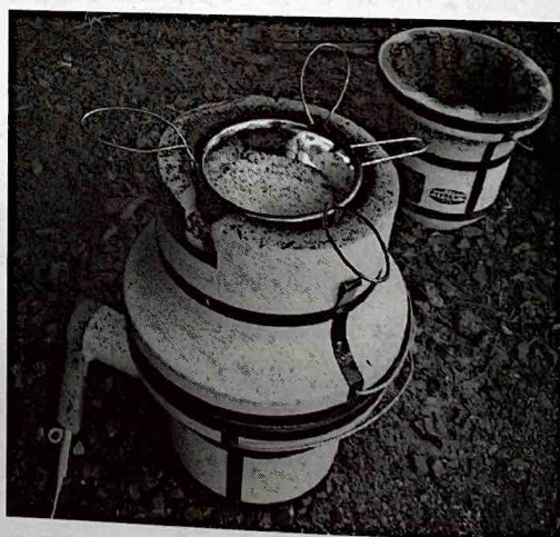
図8 二つの七輪の一方を上下逆さにして二段重ねにして作製した加熱炉 上側の七輪の底を切断し、そこにステンレス製の加熱容器を七輪内部にはめ込むようにした。
