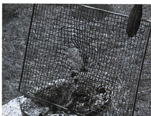
図5 1,000℃の高温で加熱した結果、溶断された鉄製金網 溶断された鉄線部分がこぶ状になっている。
