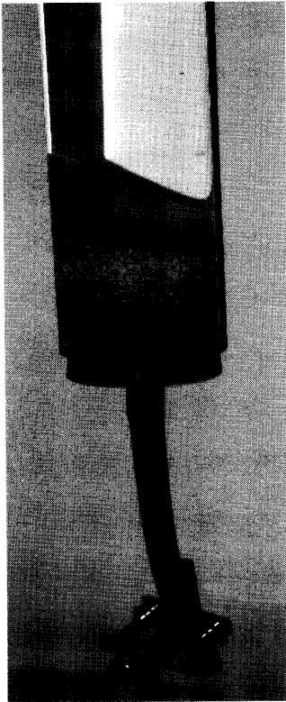
図6 教科書による条件を改善した、沈降管を使用した実験の結果。堆積粒子が上方細粒化を示して重なり、縞模様を観察することができる。また、沈降の過程を観察することで、粒径が大きい粒子から沈降することを理解することができる。
